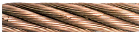
Figure D.14 - Fils cassés au niveau des parures
