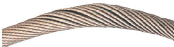
Figure D.9 - Déformation en panier
