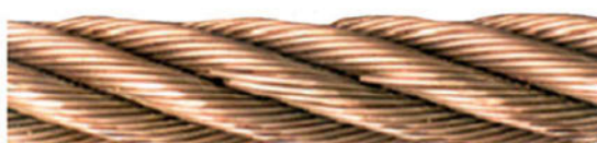
Figure D.15 - Fils cassés au niveau des sillons (parfois appelés goussets ou interstices)
